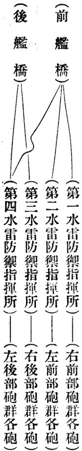
第三十一 水雷防禦通信裝置ニハ傳聲管及電話器ヲ用ヒ左ノ如ク設備ス
